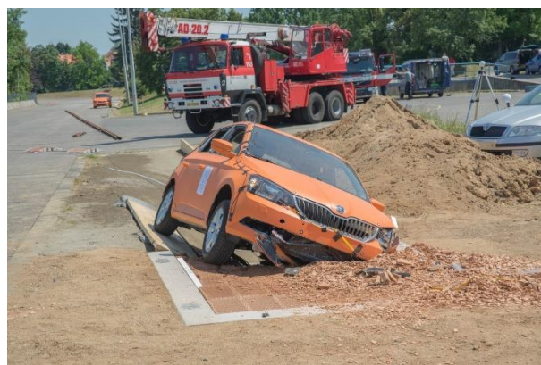
Obrázek 2 – Ukázka z dynamického testu patentované konstrukce sjezdu - fáze po nárazu vozidla.
