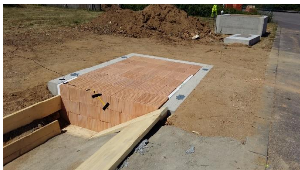
Obrázek 1 – Ukázka z dynamického testu patentované konstrukce sjezdu - fáze před nárazem vozidla.
